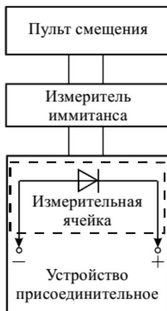
Рис. 9 Блок схема экспериментальной установки
